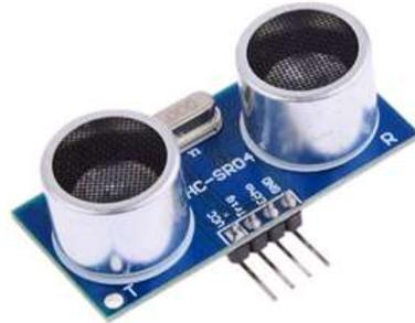
**Figura 5-7:** Sensor de distância ultrassônico
