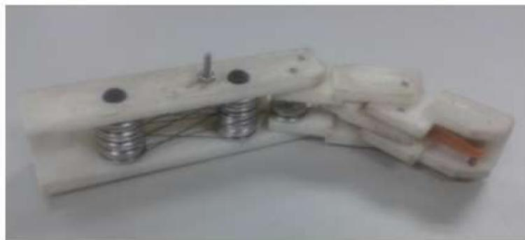
**Figura 2-11:** Protótipo de polias de desvio (LANGE, G e LACHMANN, A, 2015)
