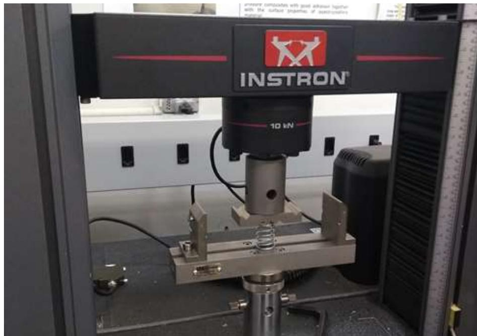
**Figura 6-1:** máquina de teste durante o teste de compressão da mola de aço (fonte própria)
