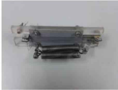
**Figura 2-12:** Atuador de SMA (LANGE, G e LACHMANN, A, 2015)
